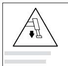
D7 - Dit sticker weergeeft de maximale belasting uitgeoefend op de grond door de stabilisator en de maximale weerstand die de grond moet uitoefenen om de machine te dragen.
